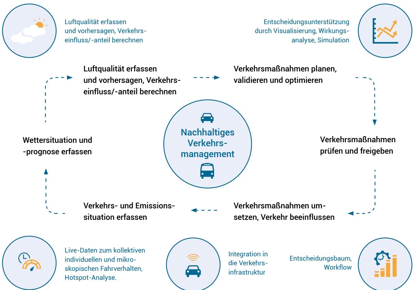
Abbildung 4: Funktionsweise eines nachhaltigen Verkehrsmanagements mit umweltsensitiver Verkehrssteuerung
